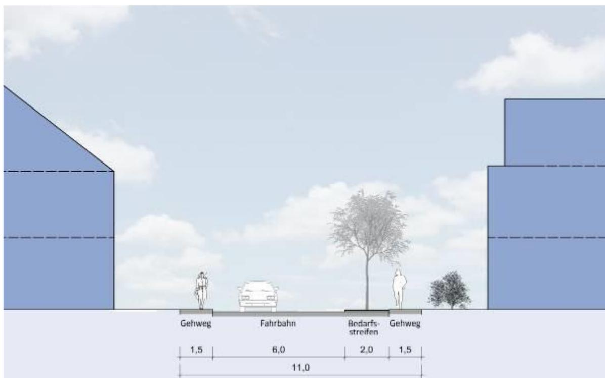
Abbildung 5: schematischer Schnitt der Planstraße A
